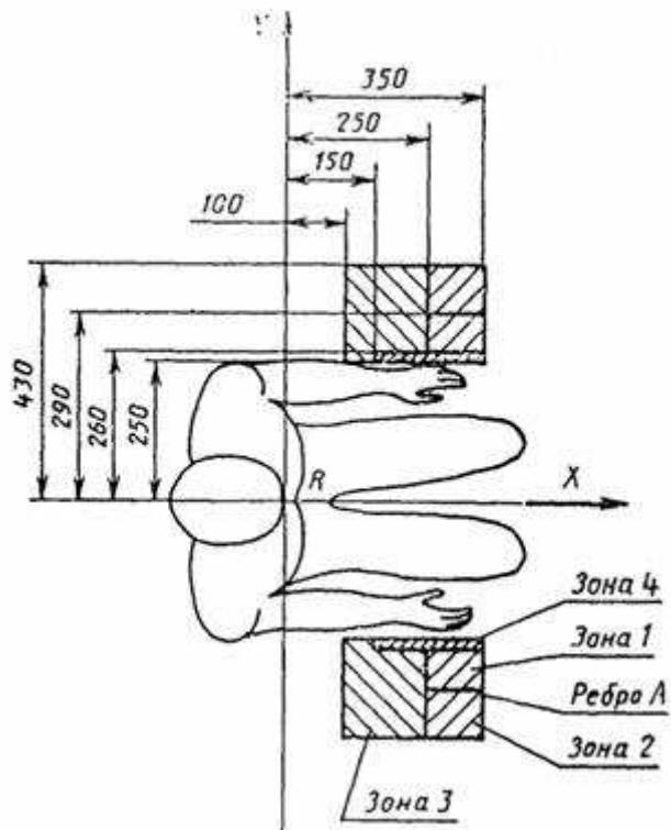
2. Центры рукоятей управления в крайнем положении контроллера и приводные элементы кнопочного управления краном должны располагаться в одной горизонтальной плоскости
